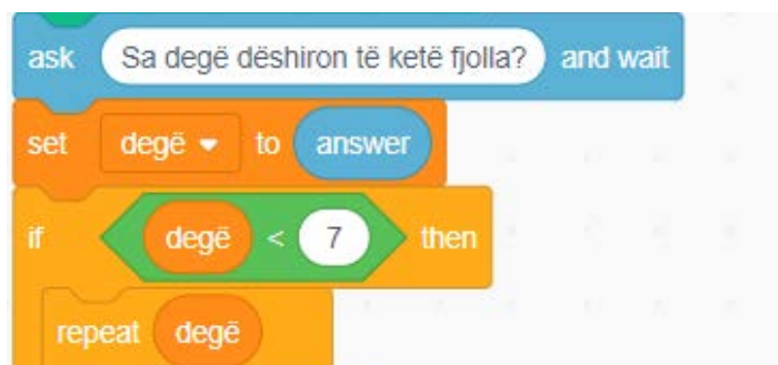
Figura 2. Cikli kusht që do të vizatojë fjollën vetëm nëse numri i degëve është më pak se 7, ndërsa për vlerat tjera mund të shkruhet mesazh në ekran.
